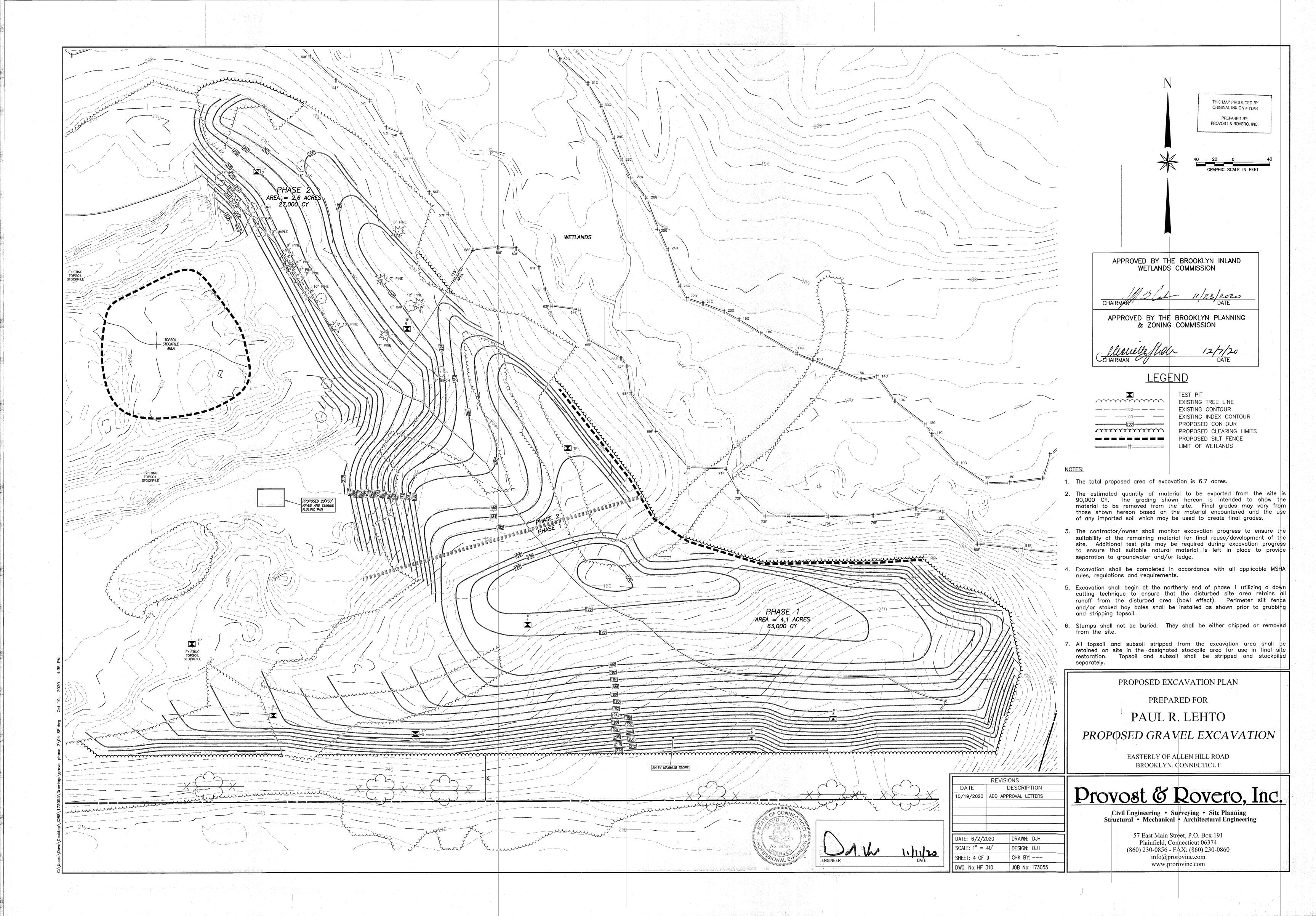
EROSION AND SEDIMENT CONTROL PLAN
